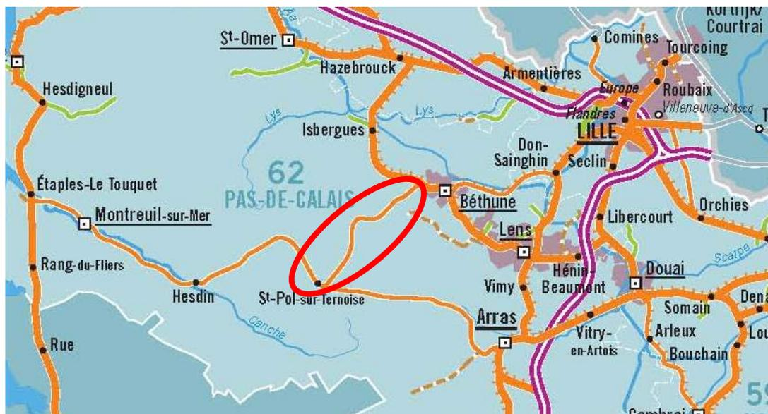
**Objectif visé par l'opération** : Moderniser la portion de ligne afin d'augmenter la capacité de la voie unique entre St Pol et Béthune et permettre le développement de la desserte TER (notamment en prolongation des trains Lille-Béthune)
